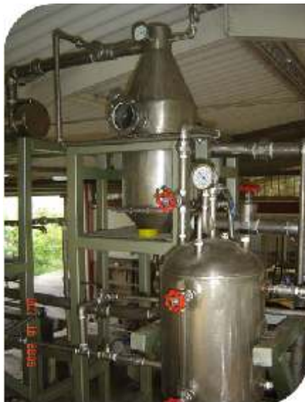
Figura 7. Detalle de un efecto del prototipo del evaporador de múltiple efecto instalado en el CIMPA.
